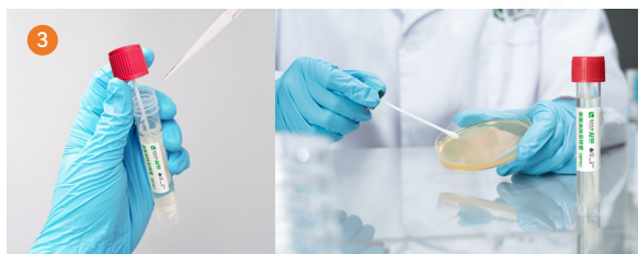
吸取采样液加入待检平板或用拭子直接涂布待检平板，培养
